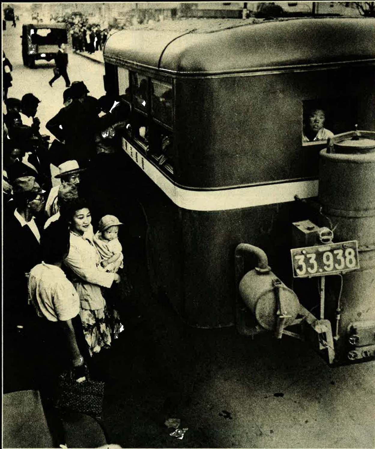
食糧の買い出し客などでスシ詰め都営の木炭バス。お尻に大きな釜をつけている。木炭バスは、燃料が軍事優先で民間へまわってこなかった戦争中に考案されたが、戦後も重要な交通手段として利用された(昭和21年10月)
